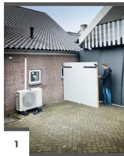
1. kép Mérés zajszigetelő burkolat nélkül
