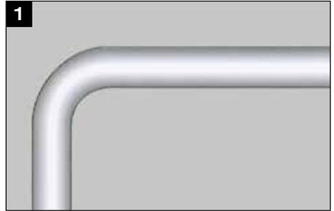
Bei bereits installierten Rohren muss der Kaiflex Schlauch der Länge nach geschlitzt werden. ● Um das anschließende Verkleben zu vereinfachen, ist es ratsam, nur sehr scharfe Messer zu verwenden. Empfehlung: Kaiflex Keramikmesser für einen sauberen, geraden Schnitt.
