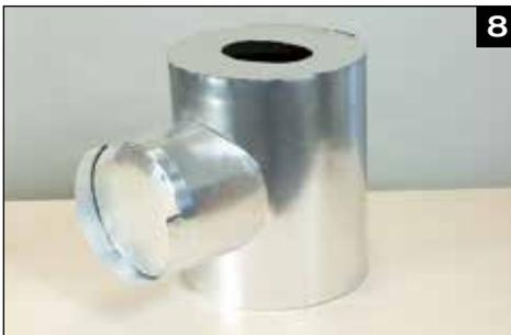
Den Stutzen mit der Haube verkleben, ggf. aus optischen Gründen oder situationsbedingt (Feuchtigkeit) Kanten, Stoß- wie auch Längsnähte mit dafür geeignetem Klebeband (Kaiflex Butyl-Alu Tape) dichten. Weitere Informationen siehe Kaiflex Protect Montageanleitung.
