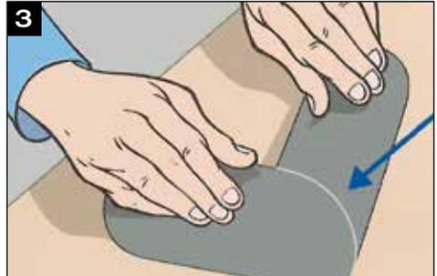
Nach Ablüften des Klebers kann der Winkel in der Innenseite längs geschlitzt werden.
