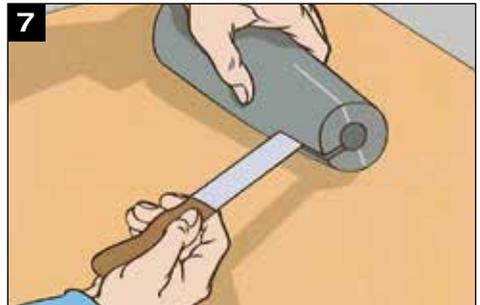
Das Reduzierstück kann an der Längsnaht und mit den Stößen der angrenzenden Schläuche verklebt werden.
