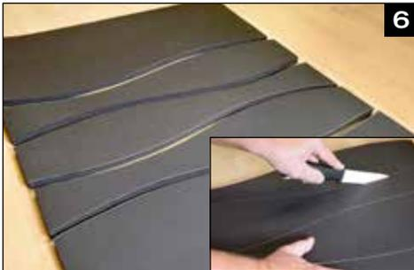
**Die aufgezeichneten Bogenteile mit einem Kaiflex Keramikmesser ausschneiden.**
