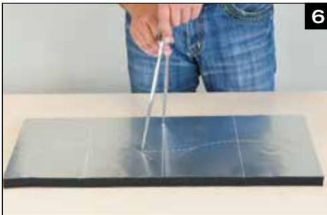
Die kurze sowie die lange Seite mit dem Zirkel abtragen, die Schnittkanten durch einen Kreisbogen verbinden.
